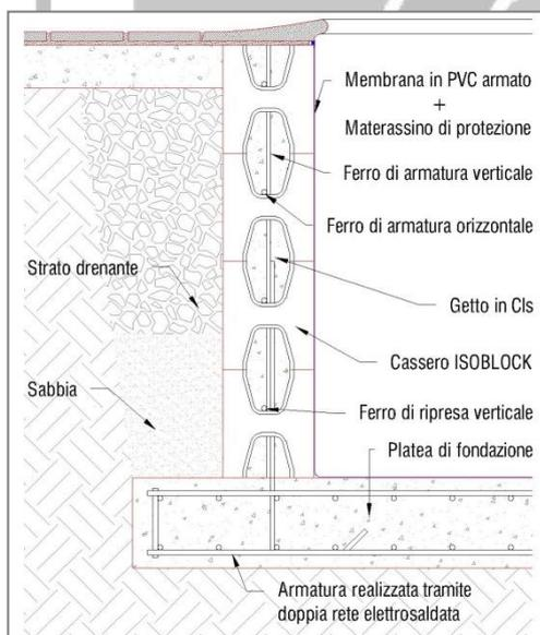
Ogni blocco, suddivisibile in 5 moduli, si presenta di dimensioni 1250\*300\*250 mm ed è disponibile in due versioni: quella dritta per la realizzazione delle forme geometriche più semplici e lineari e quella curvabile. La versione curvabile permette al cassero ISOBLOK di adattarsi ad ogni forma libera dando ampio spazio alla creatività del progettista e del cliente.
